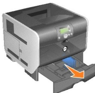
2. 查看打印机底部，找到拾纸辊臂并将它向下拉。
