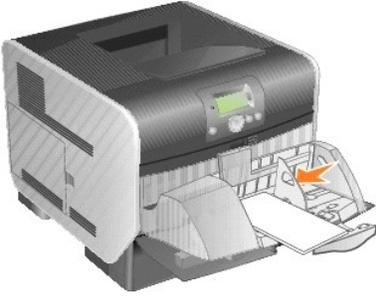
7. 放下信封压盖，使它接触到信封堆。
