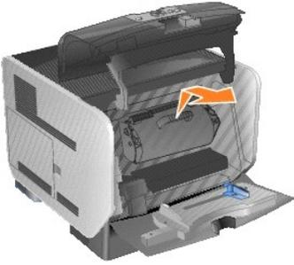
**警告：** 当更换鼓粉盒时，不要让新的鼓粉盒长时间暴露在直接的光线下。长时间光线直射会导致打印质量问题。
