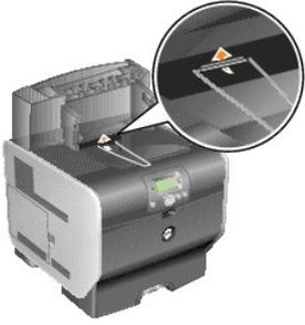
5. 将进纸匣上的底部凸柱滑动到附件接纸架上的底部插槽中。
