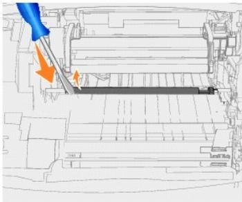
7. 提起转印辊并将它直接从打印机中拉出。将它放在一边。
