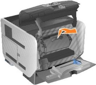
5. 找到打印机内部底部的旧转印辊。
