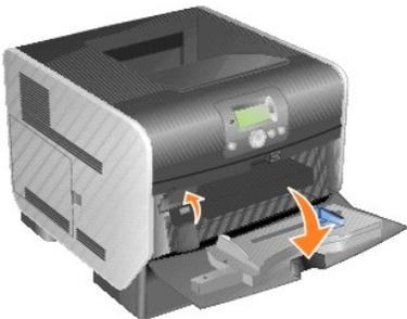
3. 将信封进纸器上的凸柱与打印机每边的凹槽对齐，然后将信封进纸器轻轻推入缺口，直到它卡入到位。
