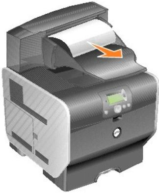
2. 向中间推接纸架后部盖门插销。后部盖门将被打开并放下。
