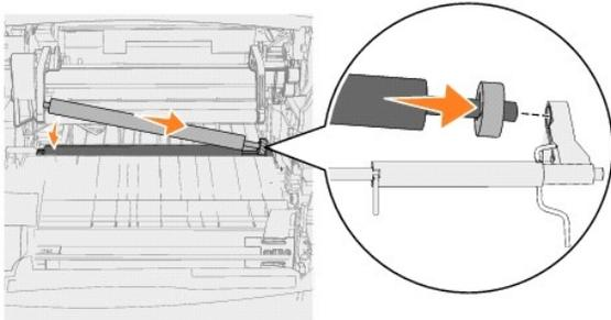
10. 轻轻地放下转印辊直到左边的金属凸柱放入插槽中。您可能需要将它向下推使它固定。
