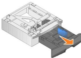
2. 将支持部件放在以前安装的进纸器顶部，或者您准备使用打印机的桌面或打印机柜上。
